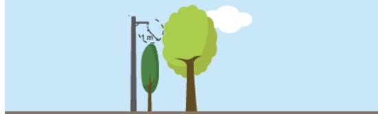
Enedis demande que l'élagage soit réalisé en augmentant d'au moins un mètre les distances prévues à la construction des lignes.
